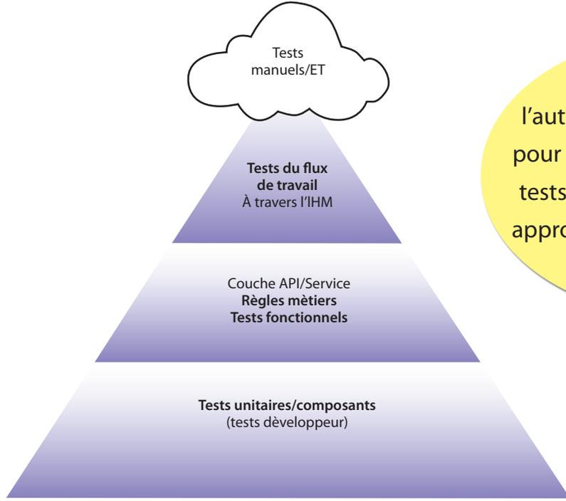
La pyramide de l'automatisation est un modèle pour aider à l'automatisation des tests et à considérer les niveaux appropriés pour l'automatisation des tests.
